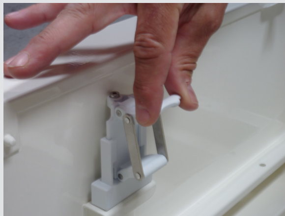
Système de serrage des filtres THE (grenouillère)
